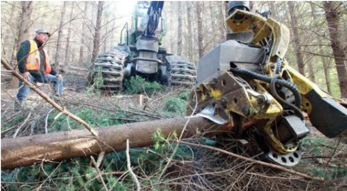
**Ein 25 Tonnen schwerer und 260 PS starker Vollernter in einem Steilhang im Wald bei Fell. Der Vollernter fällt, entastet und schneidet das Holz in einem Arbeitsgang.
